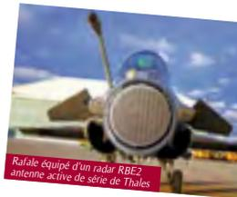
Rafale équipé d'un radar RBE2 antenne active de série de Thales
