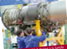
Le turboréacteur M88-2 destiné à la famille d'avions de combat Rafale en assemblage sur le site Snecma de Corbeil
